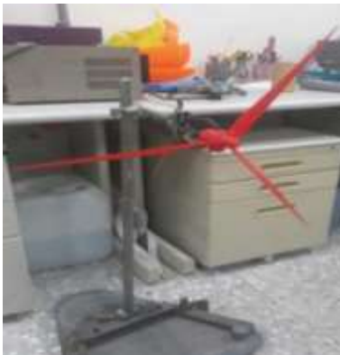
Şekil 5. 1/200 ölçekli göbek ve kanatların 3 boyutlu baskısı (Rajesh, Anand ve Nath, 2020)
