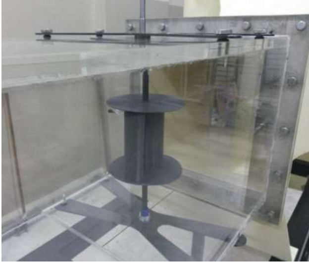
Şekil 6. Rüzgar tüneline 3D yazıcı ile yazılmış Savonius rüzgar çarkı (Deda Altan, Altan ve Kovan, 2016)
