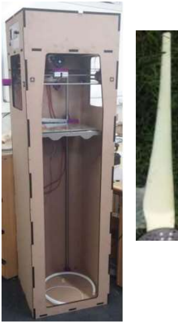
Şekil 2. Özel tasarlanmış 3D yazıcı ve rüzgar çarkı kanadı (Poole ve Phillips, 2015)
