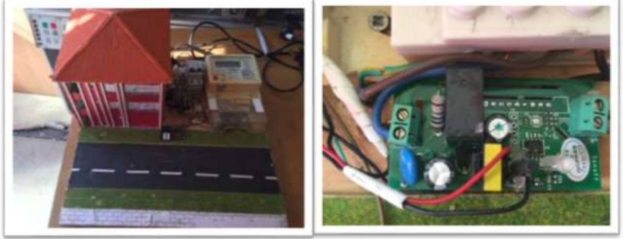
Şekil 6 Elektrik sayacı içine gömülü WifiSonoff sistem
