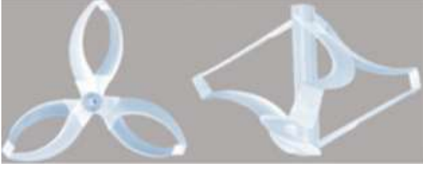
Şekil 3. Küçük Rüzgar Türbini için Döngü Tipi Kanadın Profil Tasarımı (Kim, Park, Lee ve Yoon, 2017)
