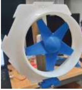
Şekil 4. Mikro Rüzgar Türbinleri için Difüzör (De Leon ve Cruz, 2020)
