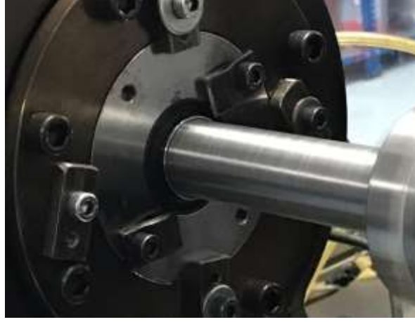
Şekil 2. Cihaz içinde keçenin mil ile temas ettiği yer
