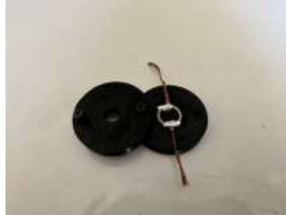
Şekil 1 İletken O-ring Kullanılan SRS Kristal Tasarımı
