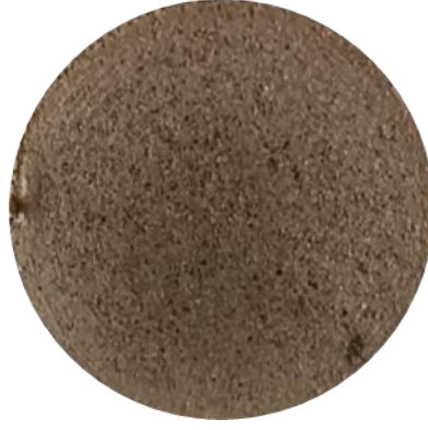
Şekil 8. 600 °C de sinterlenen numunenin makro görüntüsü
